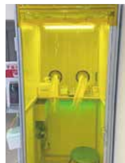
写真3 検体採取後の ブース内紫外線照射
