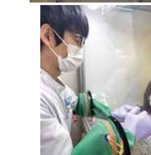
写真2 備え付けグローブを装着し 検体採取、処理している場面
